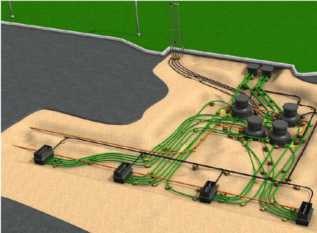
L'illustration ci-dessus présente un exemple de fonctionnement d'un système en aspiration sur une station-service. La conception du système diffère selon les pays en fonction des bureaux d'études et des règlements.
