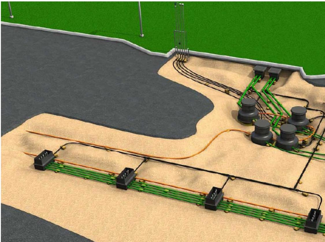
Le système de dépotage, de ventilation et de récupération de vapeur est le même pour les systèmes en refoulement que pour les systèmes en aspiration.
