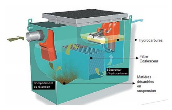
Le fonctionnement d'un séparateur est basé sur la séparation gravitaire d'éléments non solubles dans l'eau. Les eaux chargées d'hydrocarbures pénètrent dans l'appareil ou la paroi plongeante les obligent à descendre, limitant les turbulences de surface.
